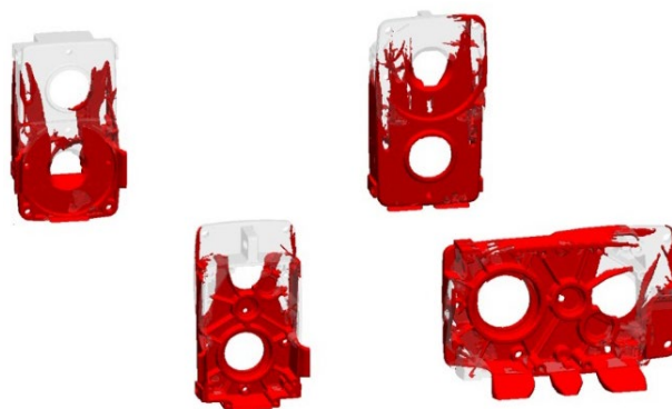
Figura 10. Comparação das frentes de fluxo na simulação para 4 posicionamentos possíveis da mesma peça, executada com o MAGMASOFT® versão 5.5.
