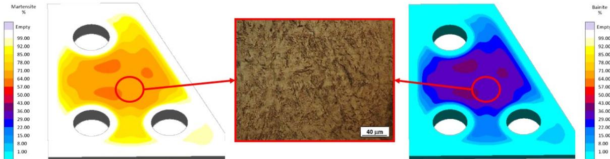
Figura 2 – Correlação microestrutural entre simulação e prática
